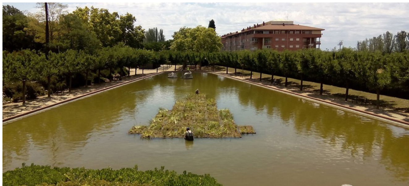
Imatge 18: Instal·lació d'illes flotants amb vegetació aquàtica al parc de Torreblanca (Sant Jon Despi/Sant Just Desvern)
